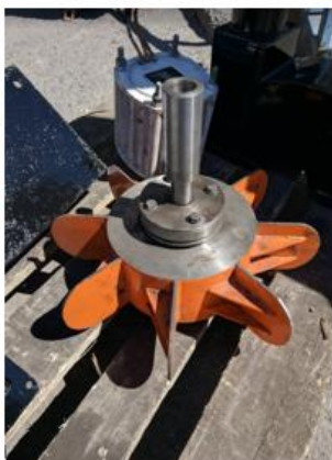
Рисунок 3.9 – Гидротурбинная установка в разборе: а – кожух и рабочее колесо; б – рабочее колесо в общем виде
