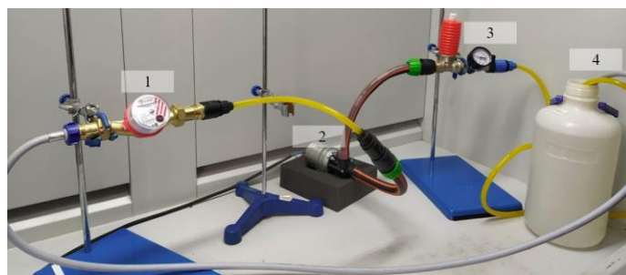
Рисунок 3.27 – Экспериментальный стенд в классической компоновке с имитацией водосборника: 1 – прибор для учета расхода воды; 2 – центробежный насос; 3 – гидравлический компенсатор с манометром; 4 – емкость, имитирующая водосборник
