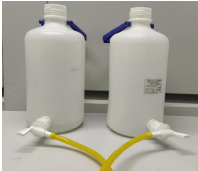
Рисунок 3.28 – Емкости с регулировкой коэффициента сообщения посредством частичного перекрытия сливных кранов
